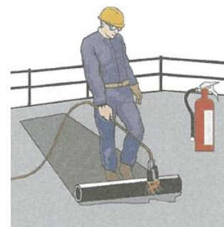
Při natavování hořákem se nahřívá spodní strana asfaltového pásu.
